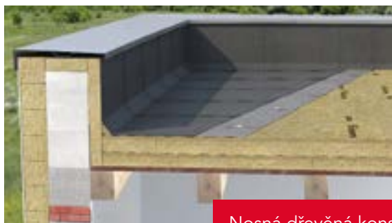
Nosná dřevěná konstrukce
