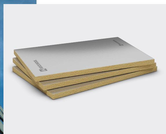
**Pannello rigido in lana di roccia ad alta densità, rivestito su un lato da un foglio di alluminio rinforzato da una rete in fibra minerale, per la protezione dal fuoco di elementi strutturali in acciaio quali travi e pilastri.**
